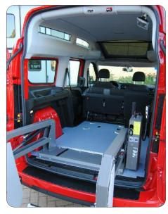
La panchetta biposto ed il sedile posteriore possono essere ripiegati completamente per consentire l'alloggiamento del trasportato in carrozzina e mantenendo tre comodi posti a sedere (cinque posti sulla versione a passo lungo del veicolo denominata XL). L'altezza del vano di carico accoglie agevolmente sia carrozzine manuali che elettroniche.
